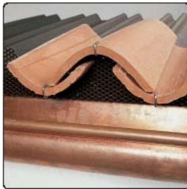
Fase 4: particolare dei coppi agganciati e dell'ampia superficie della griglia che permette la ventilazione del tetto.
